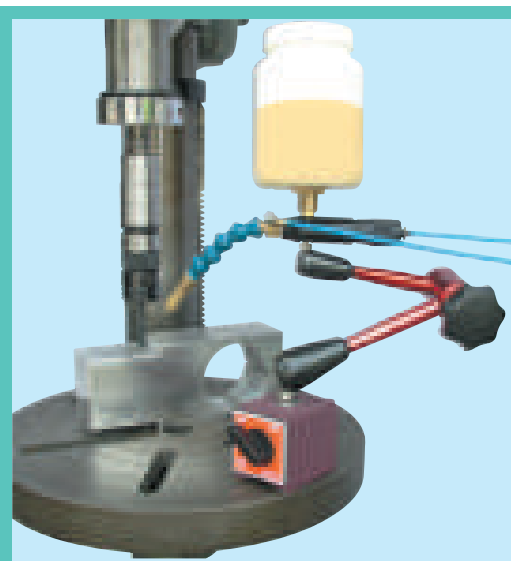
Système de Lubrification
